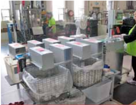
De sorteermachine met de uitstootposities voor de diverse gewichtsklassen
