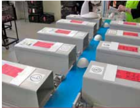
De balhelften op de lopende band tussen de uitstootposities
