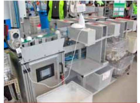
De wegende bandtransporteur met de weegcontroller
