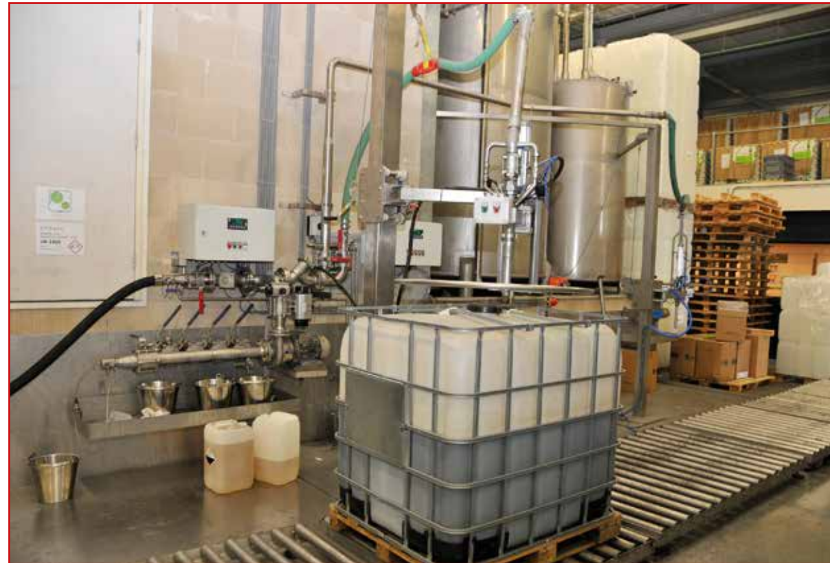
De vulinstallaties voor vloeistoffen. Deze bestaan uit twee wegend gemaakte rollenbanen met een, handmatig te positioneren, vullans. De vulbesturing bevindt zich in de kast aan de muur
