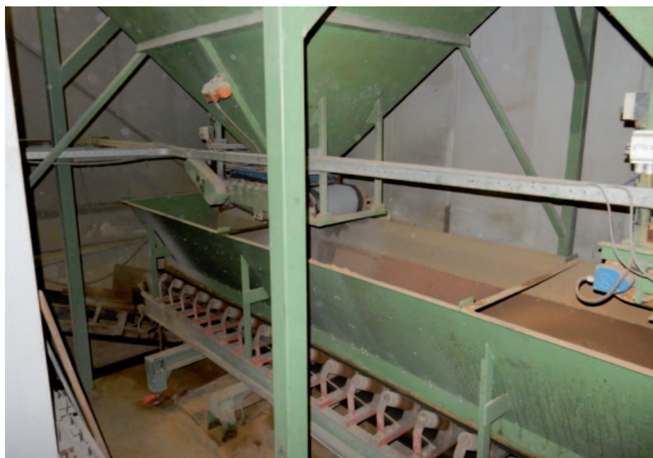
Afb. 1 Een weegband voor zand, grind en kalksteen
