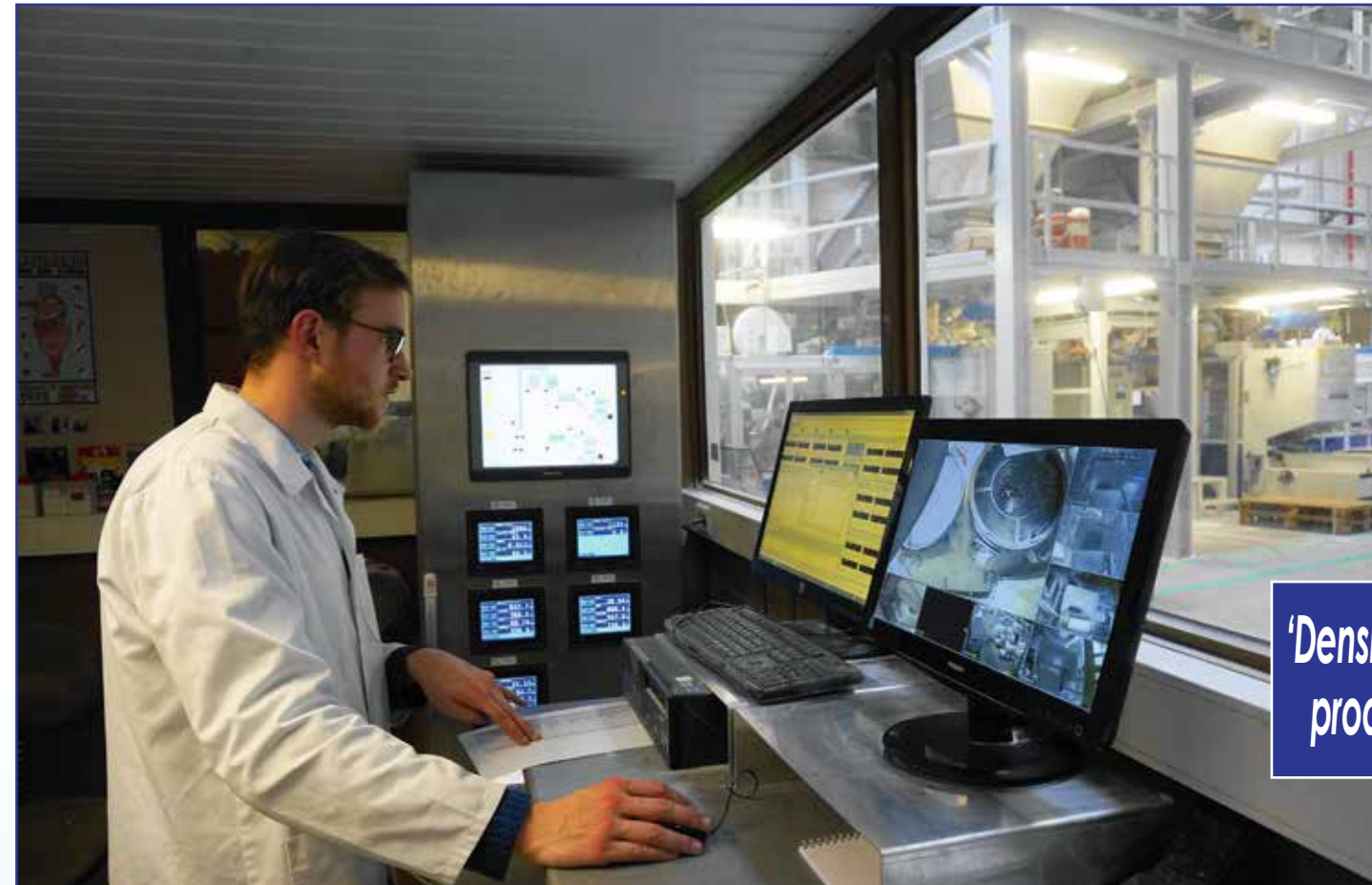
Aparte controllers in plaats van één PLC-besturing voor alle weegsystemen verbetert de weegnauwkeurigheid
