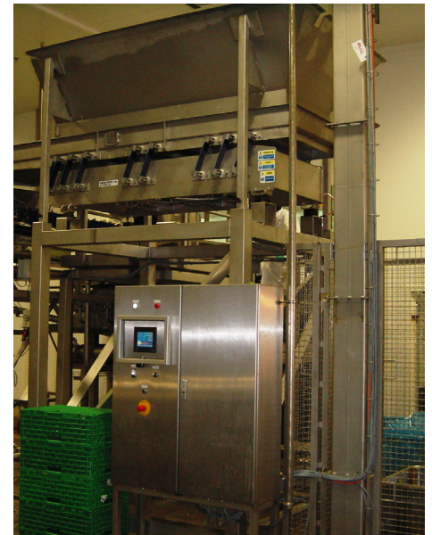
De bandtransporteur met opvangtrechter, besturings-paneel en ingebouwde weegcontroller.
