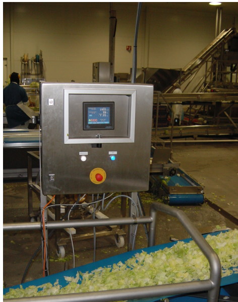
Ondanks het relatief hoge gewicht van de bandtransporteur, kon het systeem met weegbesturing worden gerealiseerd.
