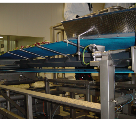
De montage van een sensor onder de bandtransporteur.
