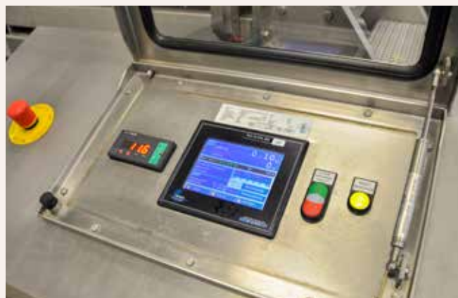
△ Twee roestvrijstalen bulkverpakkingen met de bijbehorende vulbesturing. Rechts: een bedieningslessenaar met FLEX-vulbesturing.
