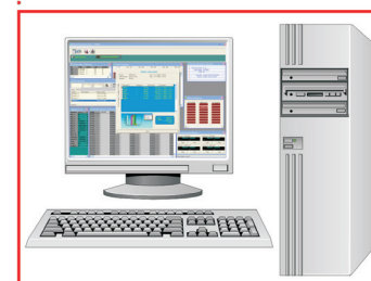
Figuur 3. Een bovenliggend controlesysteem op basis van een personal computer.
