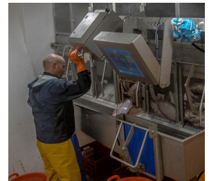
Foto 4. Een plateauweger waarop de vangst in emmers wordt verpakt.
