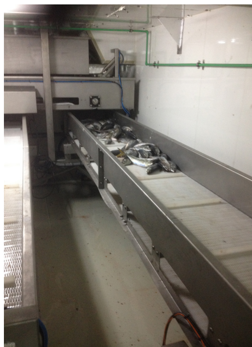
Foto 2. Een lijn voor het aan boord samenstellen van partijen vis, gemaakt en geïnstalleerd door AFAK.
