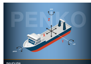
Afbeelding 1. De bewegingen om de assen van een schip ten gevolge van zeegang.
