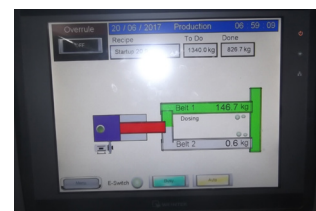
Foto 9. Tijdens het samenstellen van de batches is alle informatie over de voortgang van het proces direct beschikbaar.
