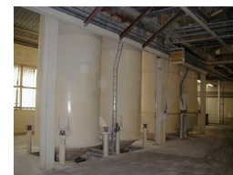
Foto 2. De silo's voor de tussenopslag van binnenkomende grondstoffen
