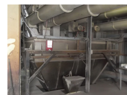
Foto 5. Het weegstelsel voor de kleine poedervormige componenten.
