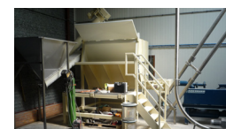
Foto 4. Een kabinet voor het handmatig invoeren van grondstoffen.
