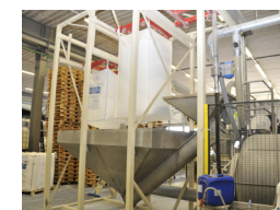
Foto 3. De invoer van grondstoffen in het proces vanuit big bags.
