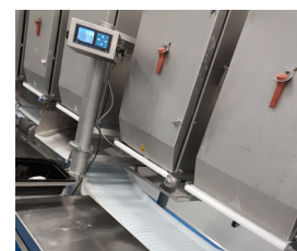
Foto 4. Een voorbeeld van een weegplateau om vooraf handmatig kleine doseringen uit te voeren.
