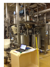
Foto 5. Een doseer- en mengtank, lossend in twee buffertanks voor het voeden van twee onafhankelijke productielijnen.
