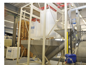
Foto 2. De invoer in het proces van kleinere, in big bags aangevoerde, componenten.
