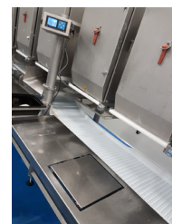
Foto 6. Een ingebouwd weegstelsel voor handmatige doseringen.
