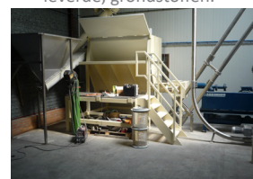
Foto 3. Een kabinet voor het handmatig invoeren van grondstoffen.
