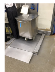
Foto 4. Een weegplateau voor het afwegen van grondstoffen.
