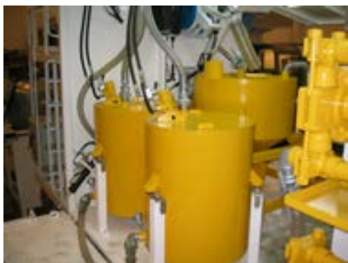
Foto 2. De continue mengselbereiding vanuit drie weegtanks.
