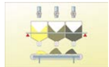
Figuur 2. Negatief doseren van drie componenten vanuit een gemeenschappelijk weegframe.
