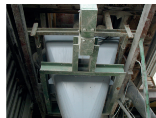
Foto 2, Een doseerbunker voor cement.
