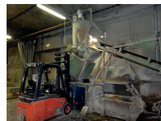
Foto 3, Vorkliftruck voor het interne vervoer van betonmengsels.
