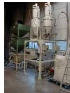
Een systeem met twee hoppers voor een continue materiaalstroom
