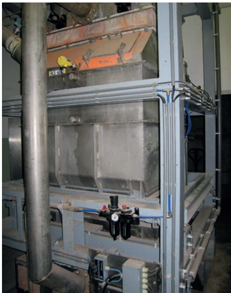
Afb. 1 Een hopperweger voor kunstmest, met een capaciteit van 3000 kg en een nauwkeurigheid van 3 000 d ofwel 0,03% (aflezing per 1 kg). De installatie kan betrouwbaar hoeveelheden vanaf 20 kg doseren
