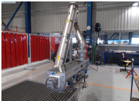
Een schroeftransporteur in de Van Beek fabriek, rechts wordt het bedieningspaneel getoond.
